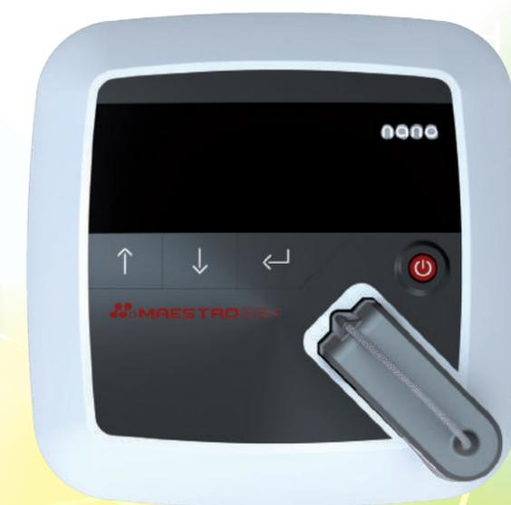
Der **MaestroGen Nano** ist ein Laborgerät zur Analyse und Bestimmung von DNA und RNA Proben mittels Lichtwellenanalyse. Das Gerät benötigt dafür nur äußerst kleine Probenmengen von 2µL und liefert bereits nach ca. 3 Sekunden erste Ergebnisse. Das Design zeigt sich klar und übersichtlich strukturiert. Die Probenaufnahme ist leicht erreichbar und die glatten Flächen lassen sich gut reinigen.
